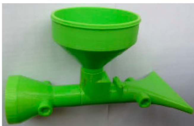
Рис. 3. – Дозирующе-высевающее устройство для расселения трихограммы
