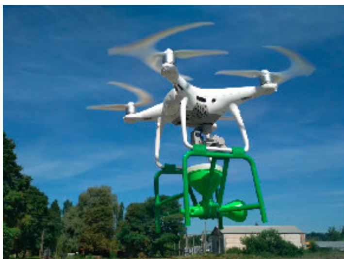
Рис. 4. – Подвес дозирующе-высевающего устройства на квадрокоптер DJI Phantom 4
