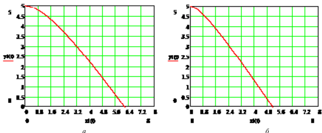
Рис. 2. – Траектория движения частицы биоматериала в зависимости от скорости витания: a – скорость витания 1,5 м/с; б – скорость витания 0,5 м/с
