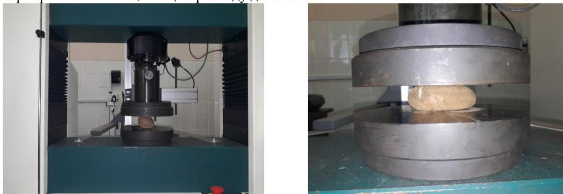
Рис. 2. Вид клубня картофеля при испытании на сжатие
