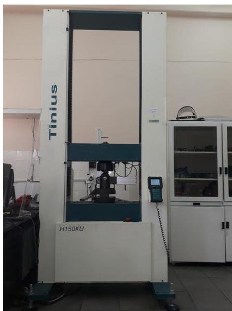
Рис. 1. Универсальная испытательная машина Tinius Olsen H150K-U
