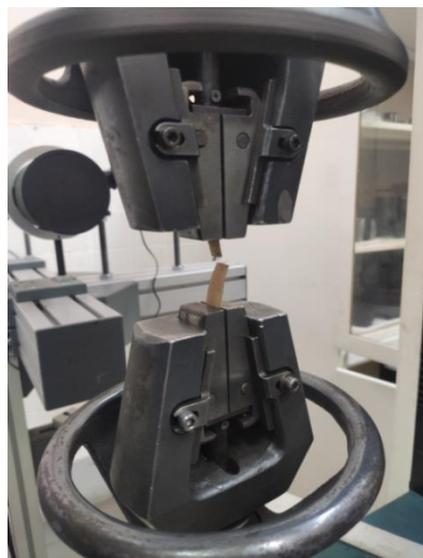
Рис. 5. – Испытание на разрыв кожуры картофеля
