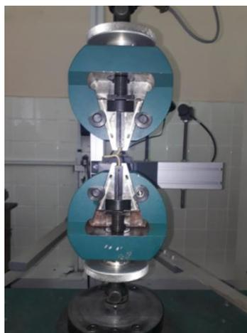
Рис. 7. Испытание на обдир образцов кожуры картофеля
