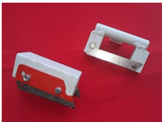
Рис. 4. Инструмент для нарезки клубней картофеля на фрагменты
