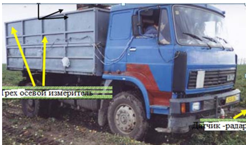
Рис. 2. Измерение скорости и ускорения автомобиля с помощью радиолокационного датчика и трёхосевого измерителя
