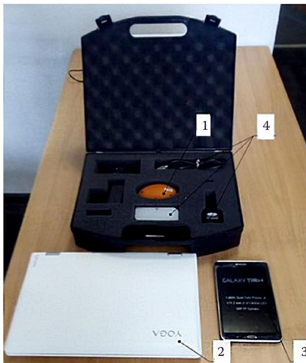
Рис. 4. Общий вид электронного клубнеплода картофеля 1 – регистратор данных; 2 – персональный компьютер; 3 – компьютер; 4 – вспомогательные инструменты
