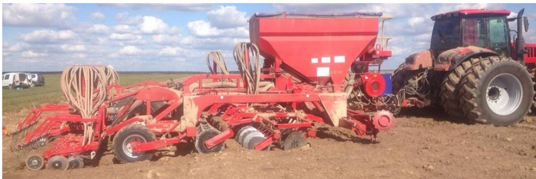
Рис. 2. Почвообрабатывающе-посевной агрегат АПП – 9 в работе
