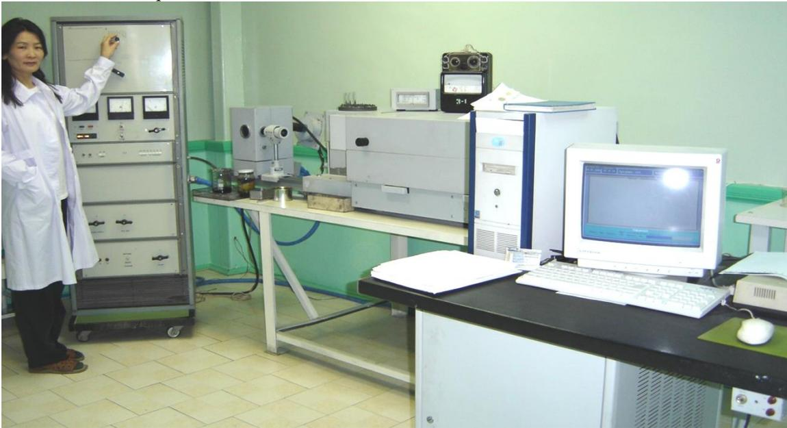
Рис. 1. Установка МФС-7М: слева у оператора источник дуги ИВС-29, правее камера для прожига масел, в центре – квантометр со вспомогательными приборами, справа - контроллер КМТ-1 и компьютер с программным обеспечением
