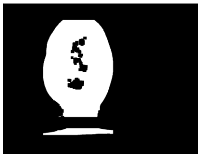
Рис. 7. Результат применения алгоритма сегментации, основанного на анализе яркости изображения
