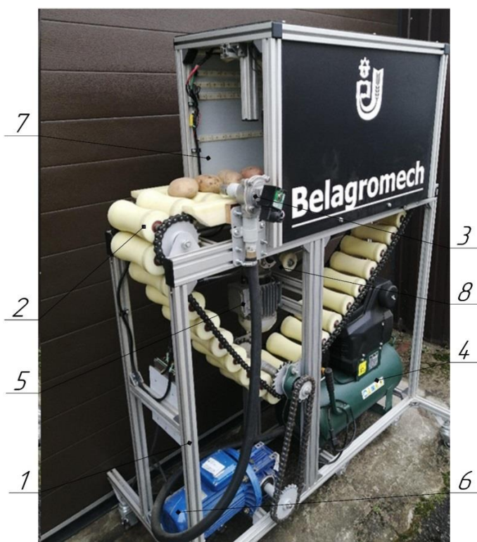
Рис. 11. Макетный образец автоматической сортировальной машины
