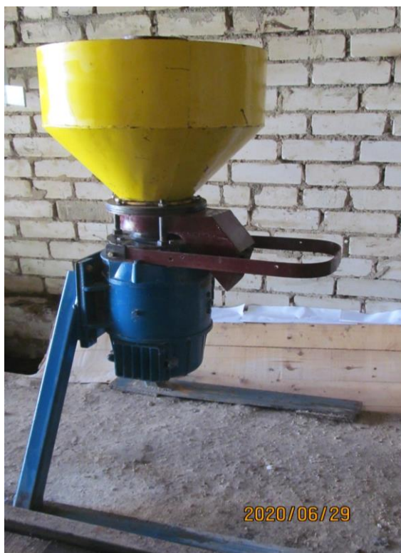
Рис. 2. Общий вид универсального измельчителя зерновых кормов мощностью 1кВт (а) и верхний диск измельчителя со сменными ножами (б).
