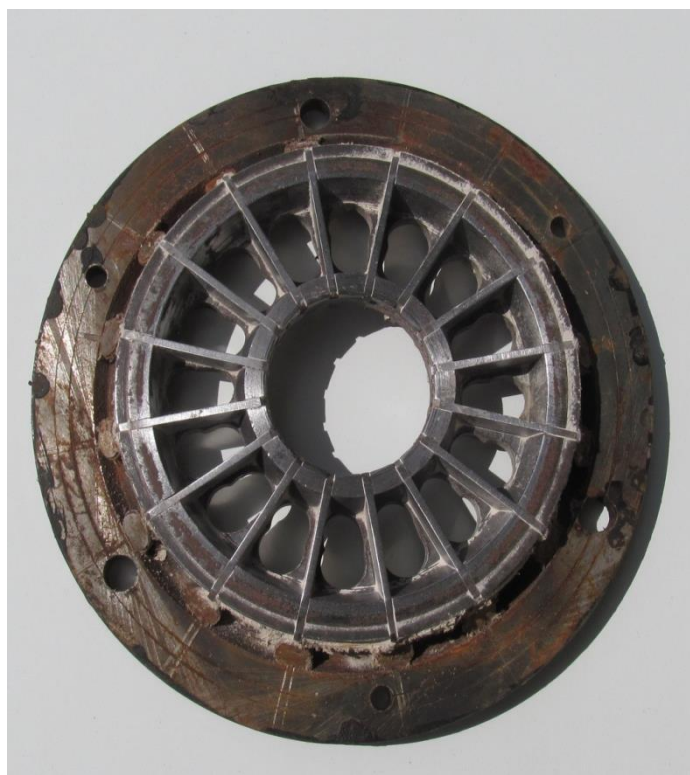
Рис. 2. Общий вид универсального измельчителя зерновых кормов мощностью 1кВт (а) и верхний диск измельчителя со сменными ножами (б).
