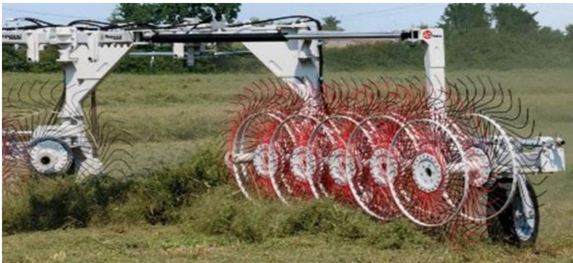
Рис. 4. Колесно-пальцевые грабли-валкователи сдвоенного типа «Ра-Рэйк 12+12» фирмы ООО «Биоком Технологии» (Республика Беларусь)
