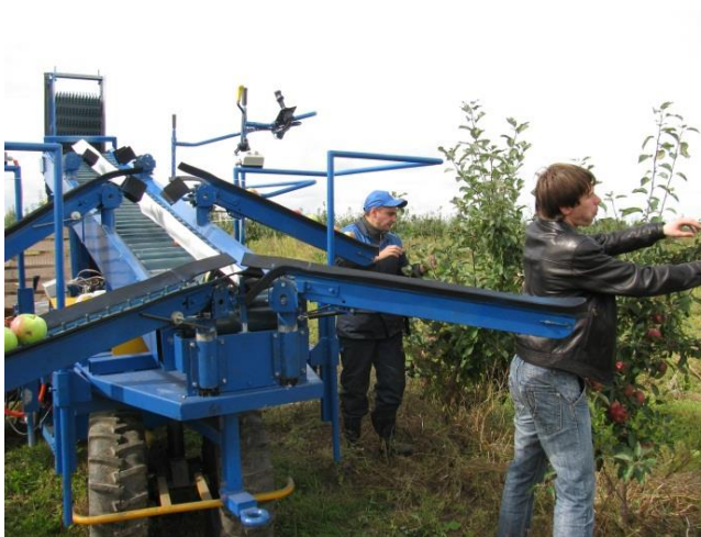
Рис. 3. Испытания агрегата АСУ-6 на уборке плодов
