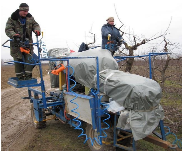
Рис. 2. Испытания агрегата АСУ-6 на обрезке веток
