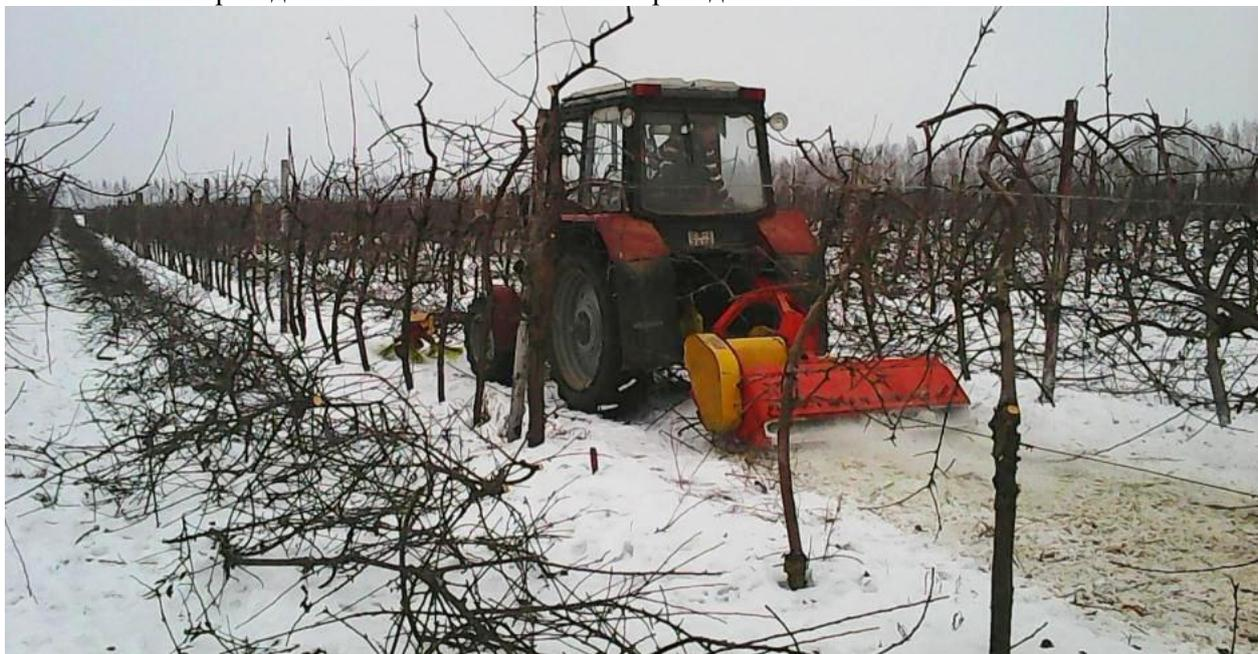
Рис. 2. Комплекс уборки веток плодовых деревьев КУВ-1,8 на испытаниях в СПК «им. В.И. Кремко»
