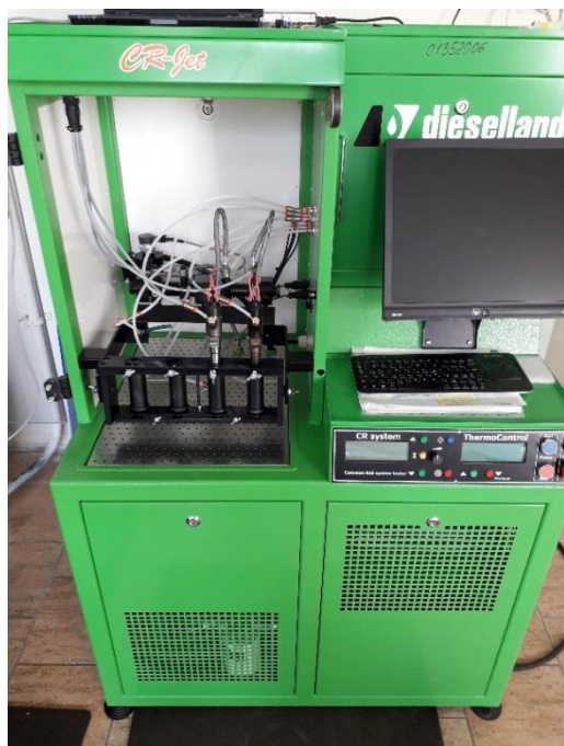
Рис. 1. Форсунки фирмы Bosh установленные на стенде для проведения исследований виброакустических характеристик
