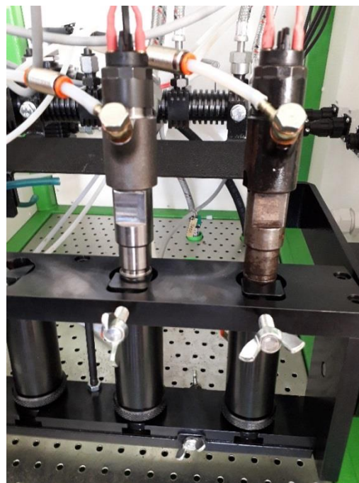
Рис. 1. Форсунки фирмы Bosh установленные на стенде для проведения исследований виброакустических характеристик
