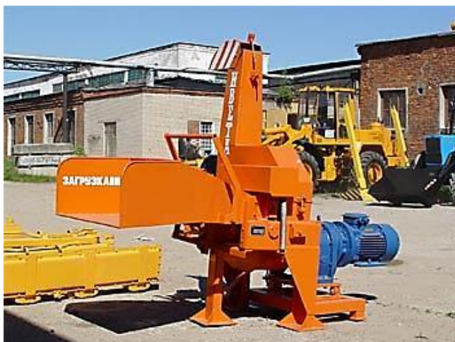
Рис. 4 – Стационарный измельчитель веток АО «Михневский РМЗ»
