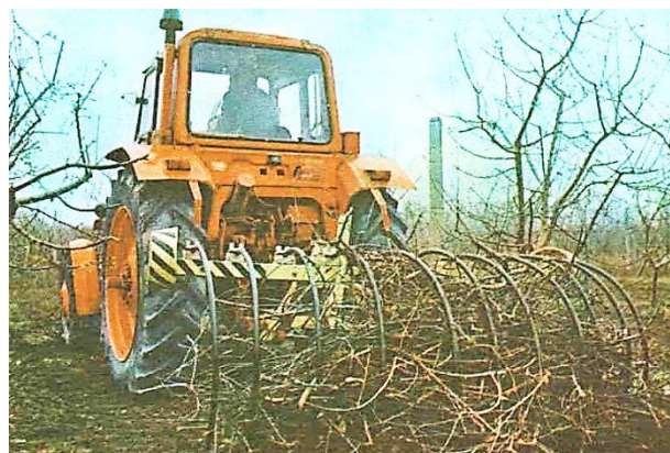
Рис. 3 – Машина для сбора срезанных ветвей СВ-1
