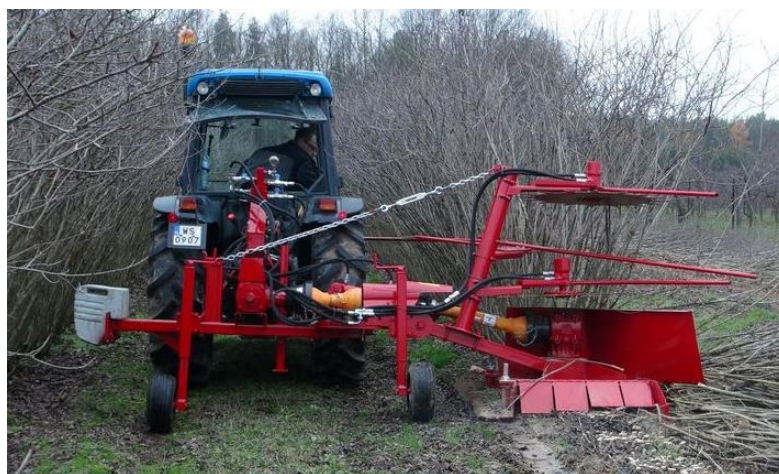
Рис. 12 – Машина для срезания кустов Berta фирмы Weremczuck
