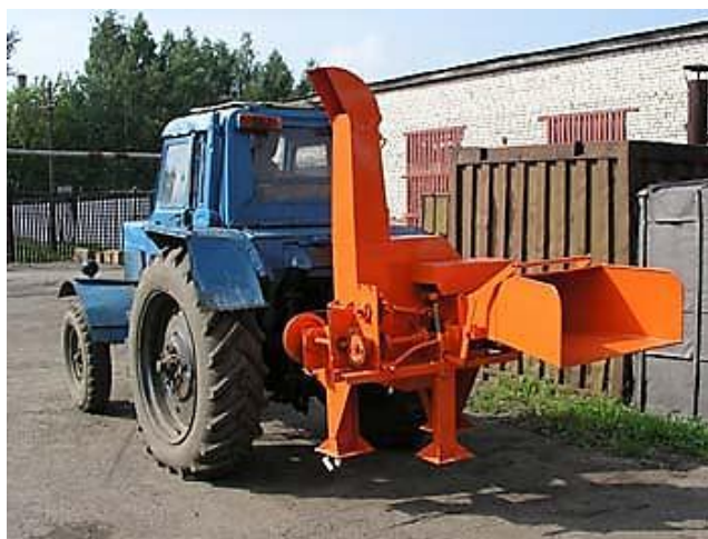
Рис. 5 – Позиционный измельчитель веток АО «Михневский РМЗ»
