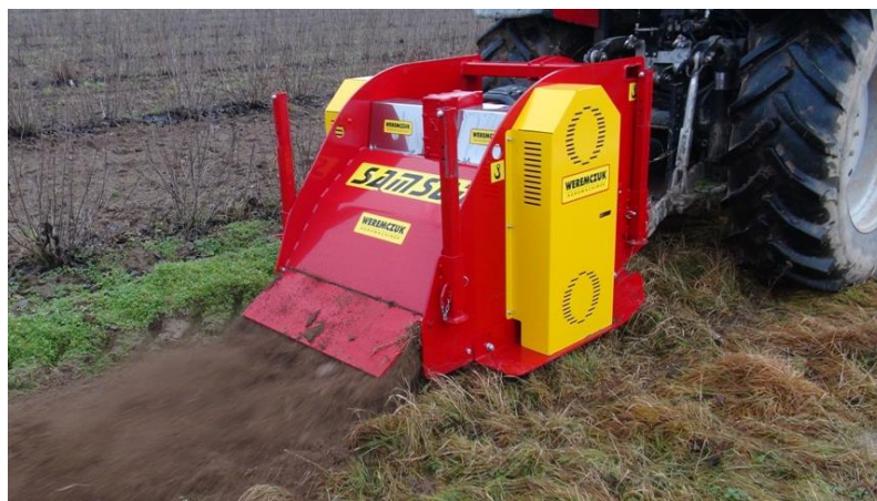
Рис. 11 – Корчеватель корневой системы многолетних насаждений Samson фирмы Weremczuck
