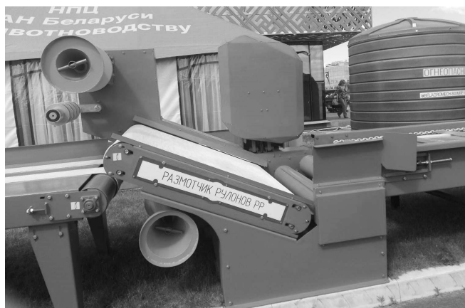
Рис. 6. Линия размотки рулонов тресты ЛРТ-2
