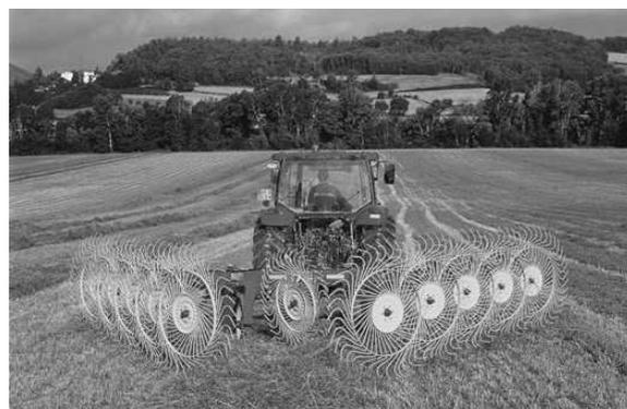
Рис. 2. Колесно-пальцевые грабли-валкователи QR 10 фирмы Sitrex S.P.A.
