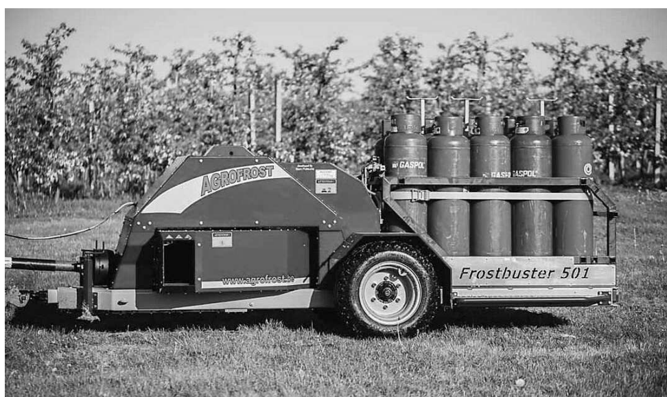
Рис. 3. Установка Frostbuster F501 (фирма Agrofrost, Бельгия)
