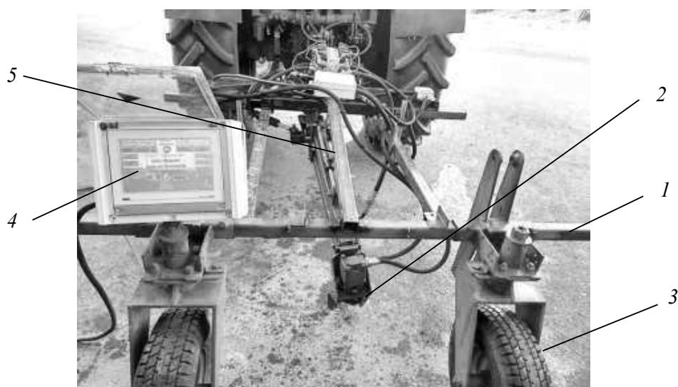
Рис. 1. Макетный образец роботизированной машины для пропалывания междурядий питомников и ягодников: 1 – рама; 2 – рабочий орган; 3 – колесный ход; 4 – система управления; 5 – гидросистема
