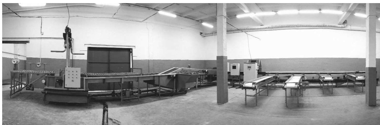
Рис. 9. Приемочные испытания опытного образца технологической линии сортировки и фасовки яблок ЛСП-4 в ОАО «Остромечеве» Брестского района
