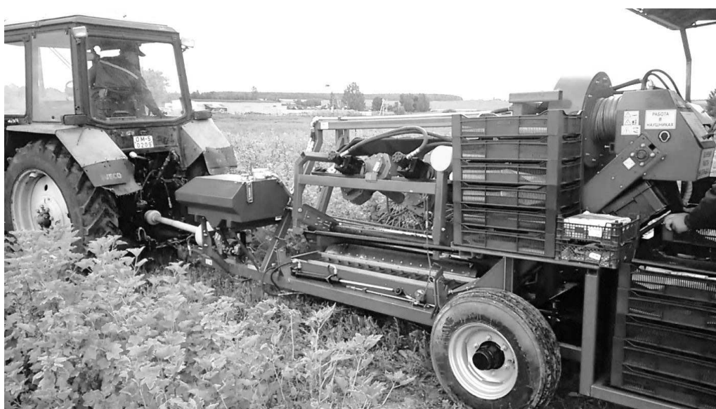
Рис. 18. Прицепной ягодоуборочный комбайн КПЯ на уборке смородины. ГП «Восход». Минский район. 2019 г.
