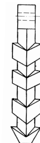
Рис. 2. Трехгранная стойка с почвоподъемными пазами
