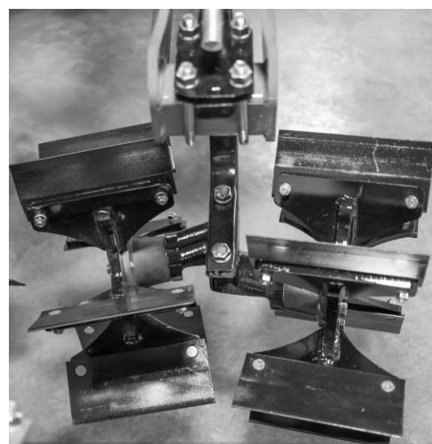
Рис. 16. Ножевидный диск фирмы Great Plains (США)
