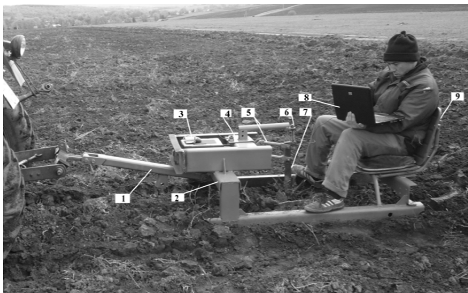
Рис. 3. Сани для измерения тягового сопротивления [4]: 1 – саница; 2 – рама; 3 – измерительный комплекс; 4 – каретка; 5 – подвеска; 6 – регулятор глубины обработки; 7 – рабочий орган; 8 – компьютер; 9 – сидение для оператора
