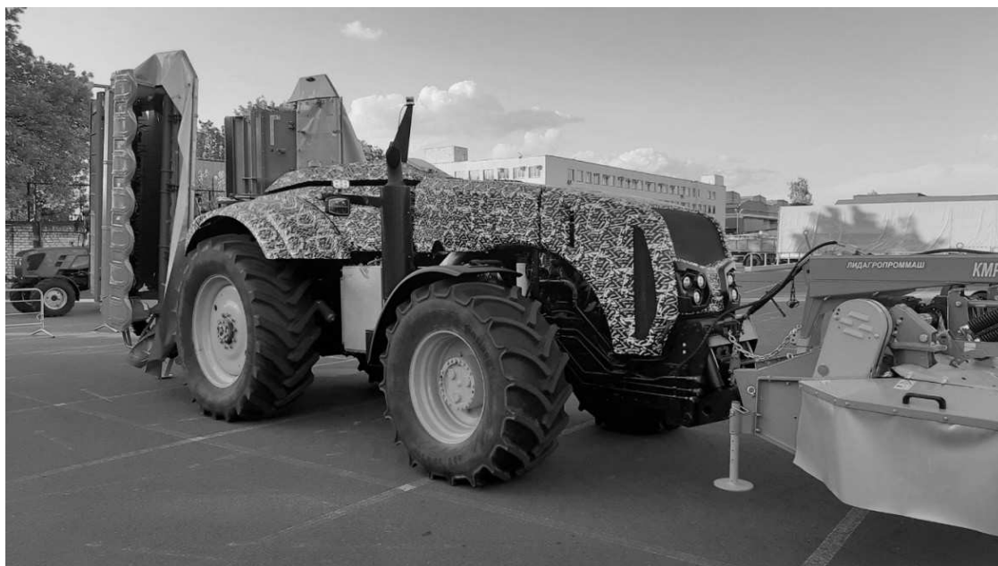
Рис. 2. Макетный образец робототехнического комплекса на базе трактора Беларус-3522
