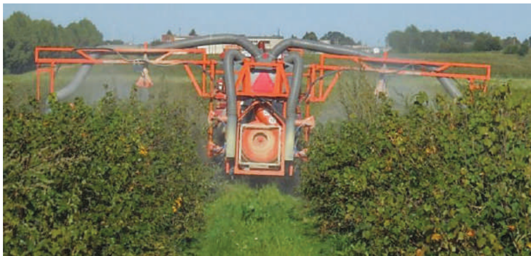
Рис. 2. Опрыскиватель ОД-2 в агрегате с трактором «Беларус-921.3» на химической обработке кустов смородины
