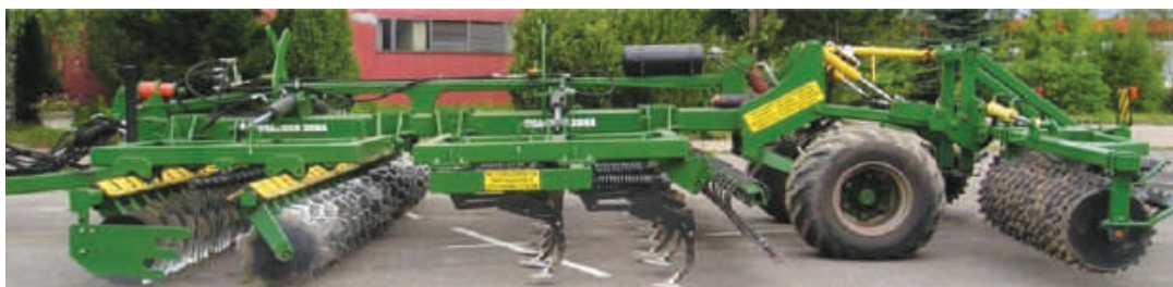
Рис. 3. Агрегат почвообрабатывающий многофункциональный АПМ-6 в комплектации с дисковыми и лаповыми рабочими органами
