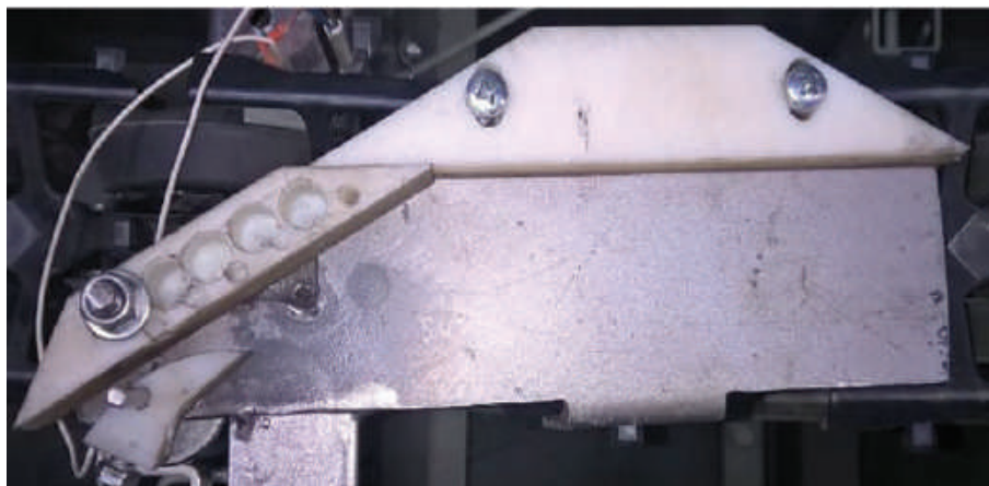
Рис. 2. Исполнительный механизм сбрасывателя плодов с управляемым соленоидом
