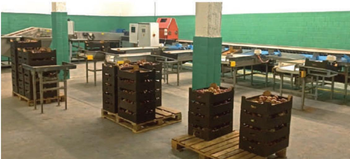
Рис. 14. Технологическая линия сортировки и фасовки яблок ЛСП-4
