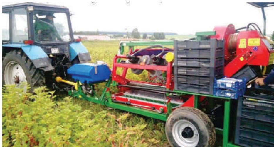
Рис. 11. Прицепной ягодоуборочный комбайн КПЯ
