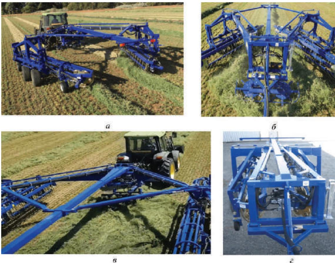
Рис. 8. Грабли-валкователи гребенчатого типа BR1200С фирмы «Berrima Engineering»:
