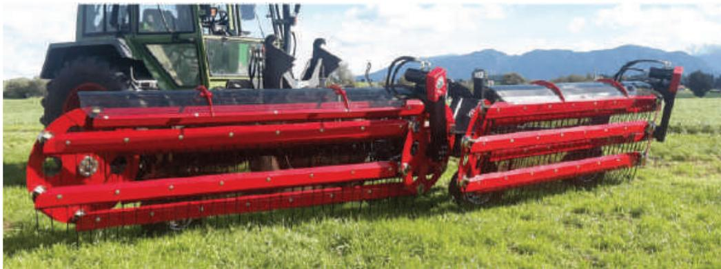
Рис. 6. Грабли-валкователи гребенчатого типа Clementer 550 F фирмы «Umwelttechnik»
