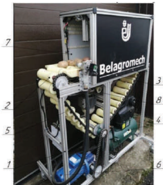
Рис. 6. Макетный образец автоматической сортировальной машины: 1 – рама; 2 – вальцово-подающий конвейер; 3 – пневматическая система отделения; 4 – компрессор; 5 – мотор-редуктор 2ЧМ-40; 6 – мотор-редуктор МПЧ-25М1; 7 – система распознавания; 8 – приводной ремень
