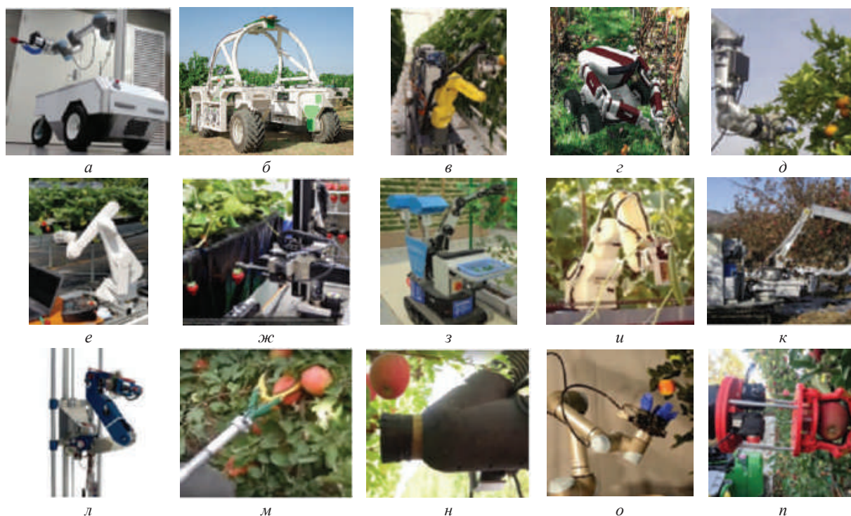
Рис. 4. Примеры роботов для ухода за виноградниками и уборки фруктов: а) HarveyQueensland; б) TED Naïo Technologies; в) SWEEPER; г) Wall-Ye 1000 mobile; д) Citrus robot University of Florida; е) DogTooth; ж) Shibuya Seiki; з) Tomato harvesting robot; и) Cucumber robot Wageningen UR; к) Apple harvesting robot; л) Apple harvesting; м) Apple picker; н) Apple picking vacuum; о) UR5 apple robot; п) Apple catching Washington State University
