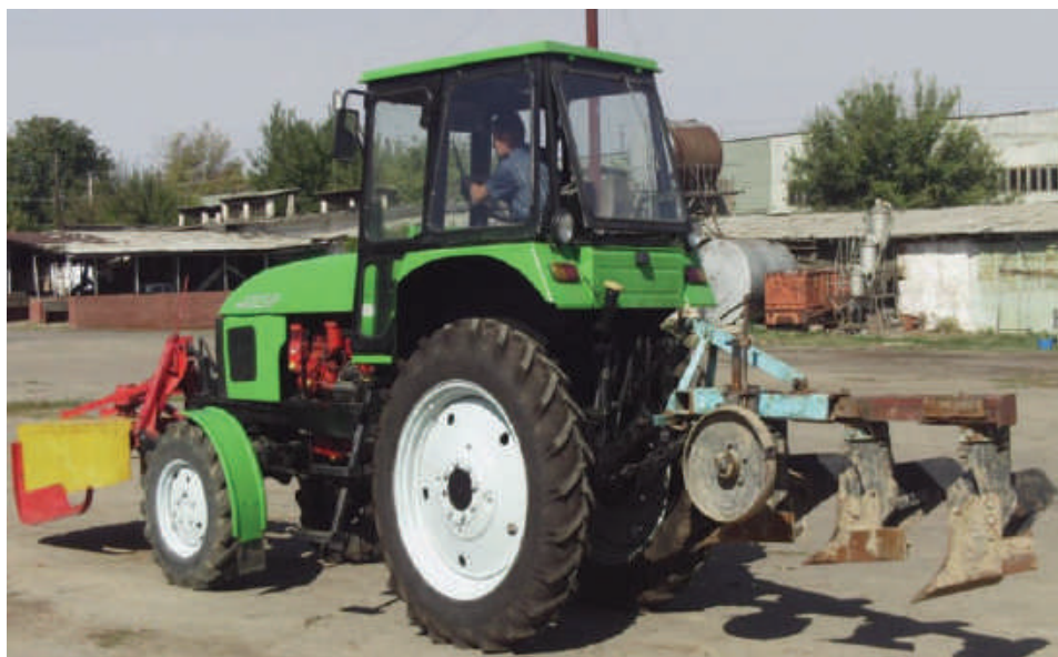
Рис. 2. Комбинированный агрегат, навешиваемый на овощеводческий трактор ТТЗ-100SP, состоящий из стеблеизмельчителя и плуга
