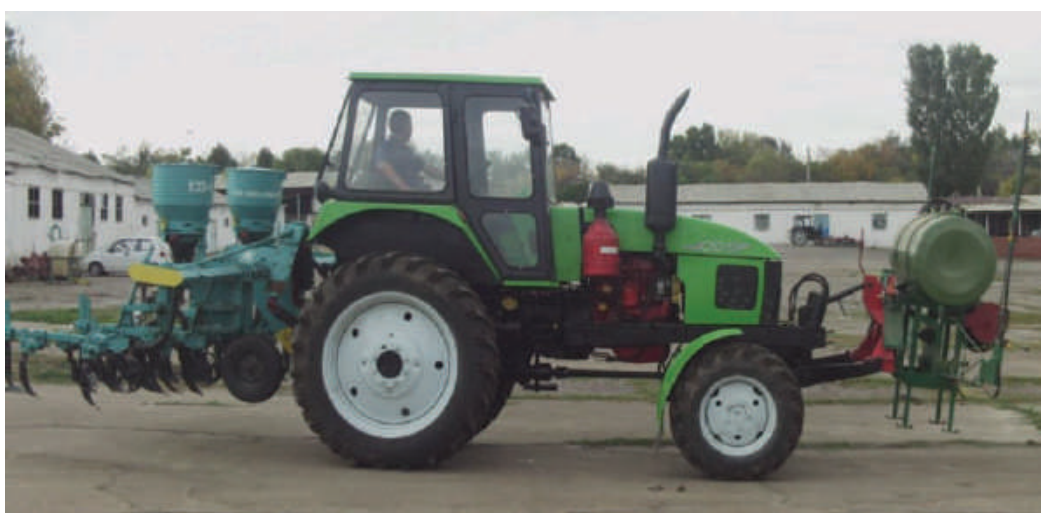
Рис. 4. Комбинированный агрегат, навешиваемый на овощеводческий трактор ТТЗ-100SP, состоящий из опрыскивателя и культиватора
