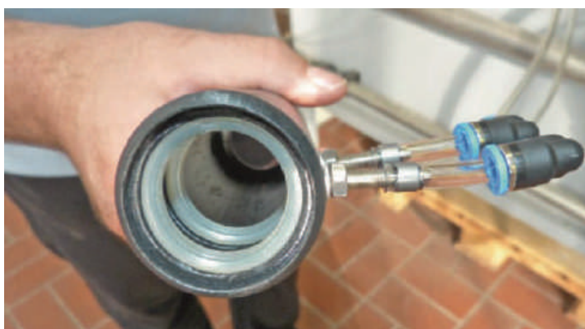
Рис. 1. Доильный стакан с надувными кольцами
