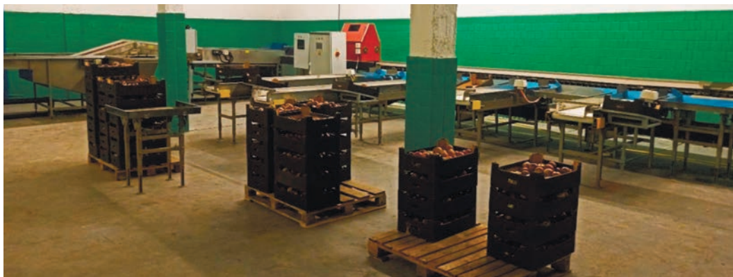
Рис. 5. Технологическая линия сортировки и фасовки яблок ЛСП-4
