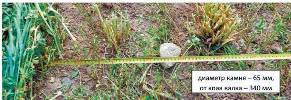
Рис. 3. Расположение камней после прохода граблей колесно-пальцевых с рабочими органами сдвоенного типа
