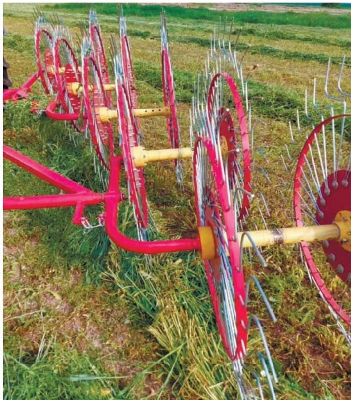
Рис. 1. Сгребание провяленной люцерны граблями колесно-пальцевыми с рабочими органами сдвоенного типа
