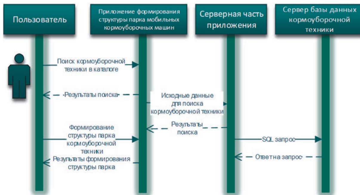
Рис. 1. Диаграмма последовательности функционирования программного приложения для автоматизированного формирования структуры парка мобильных кормоуборочных машин
