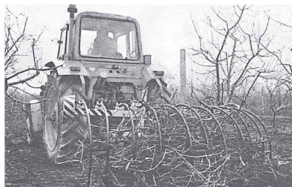
Рис. 3. Машина для сбора срезанных ветвей СВ-1
