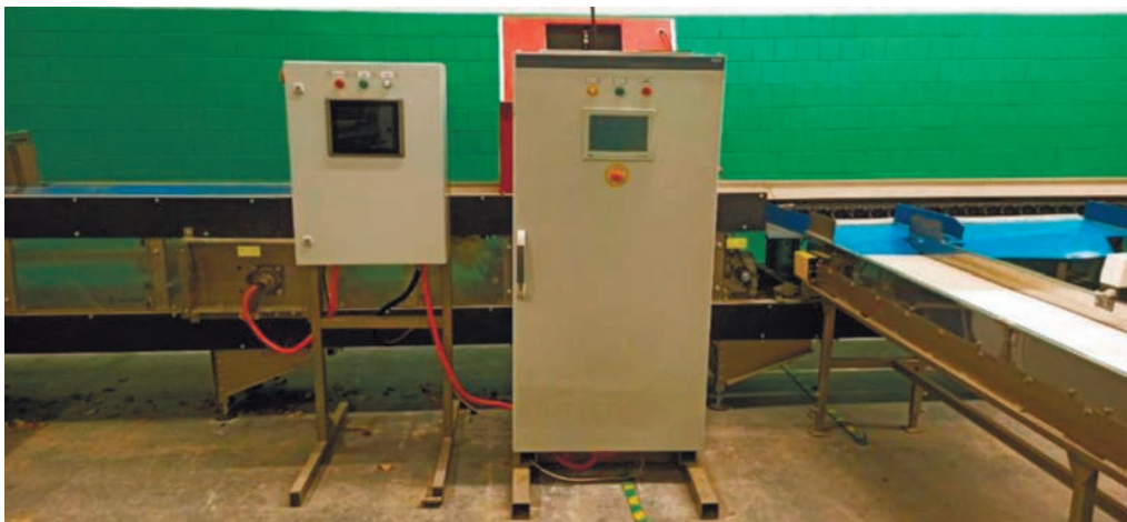
Рис. 5. Технологическая линия сортировки и фасовки яблок ЛСП-4 на испытаниях в ОАО «Остромечев»
