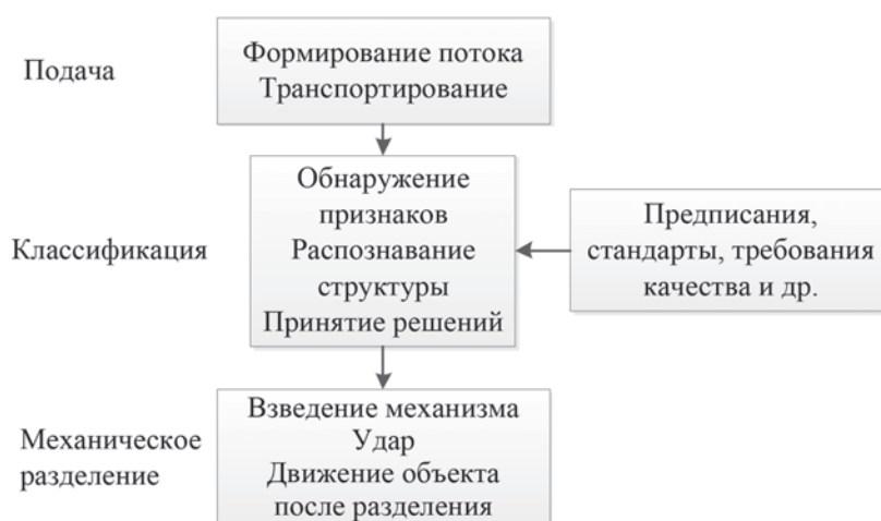
Рис. 1. Функциональная схема системы сортировки плодов по качеству
