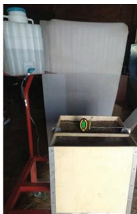
Рис. 2. Исследование параметров физического моделирования капельного орошения
