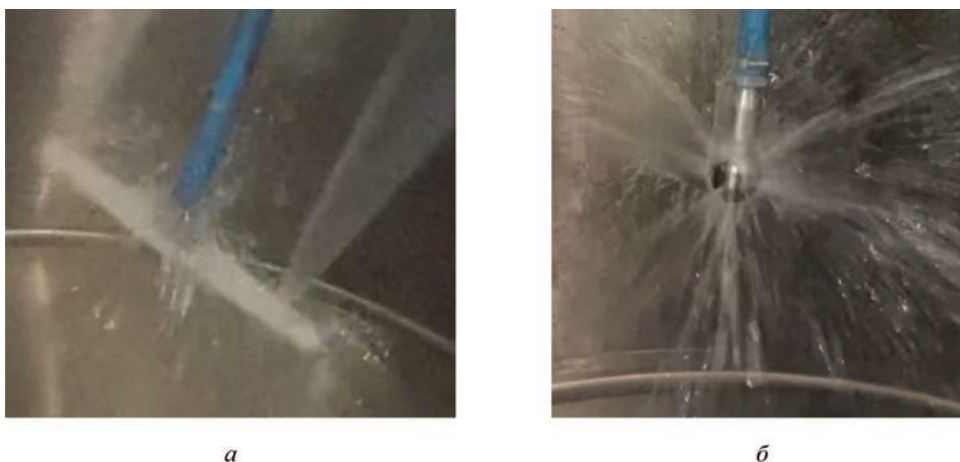
Рис. 10. Распыление жидкости струйными распылителями: а – распылитель «Гомельагрокомплект»; б – макетный струйный распылитель
