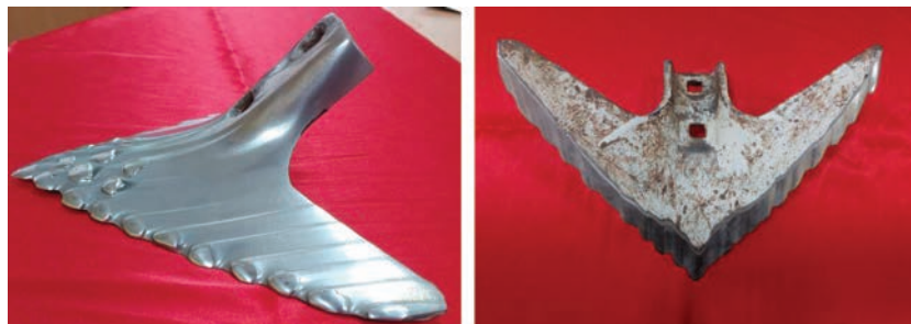
Рис. 4. Изношенная лапа № 3: а – вид сбоку; б – вид снизу
