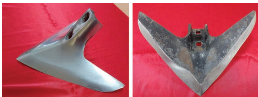
Рис. 2. Экспериментальная лапа № 1 (серийная): a – вид сбоку; б – вид снизу
