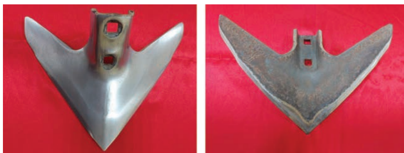
Рис. 2. Экспериментальная лапа № 1 (серийная): a – вид сбоку; б – вид снизу
