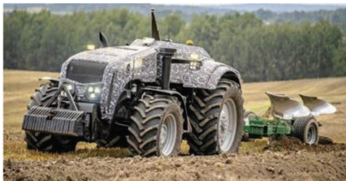
Рис. 2. Автономный беспилотный трактор «БЕЛАРУС-А3523i» с электромеханической трансмиссией
