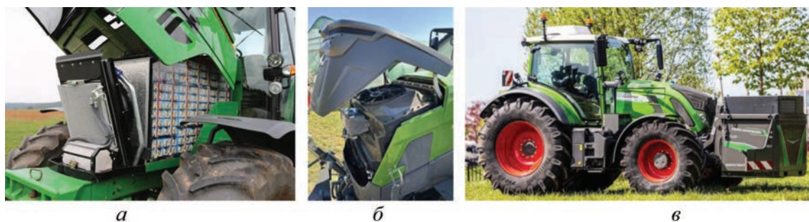
Рис. 6. Установка высоковольтных аккумуляторных батарей в моторном отсеке тракторов John Deere SESAM (а), Fendt e107 V Vario (б) и на тягах ПНУ трактора Electric 700 Vario фирмы Agromec (также используется в качестве переднего балласта) (в)
