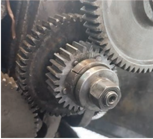
Рис. 11. Сменная цилиндрическая шестерня, установленная в механизм деления зубофрезерного вертикального полуавтомата 5E32
