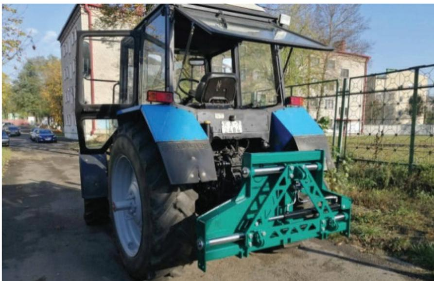
Рисунок 1 – Автоматическая управляемая навесная система
