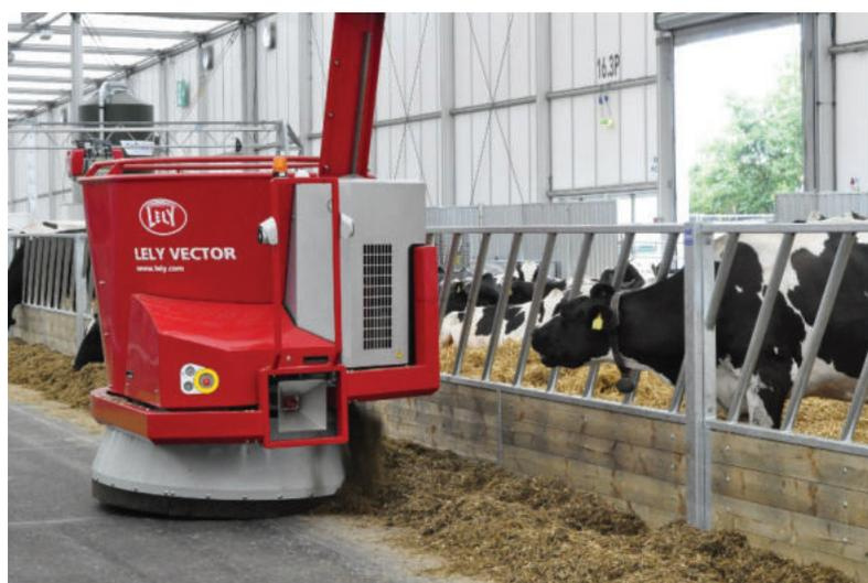
Рисунок 21 – Робот-кормораздатчик Lely Vector
