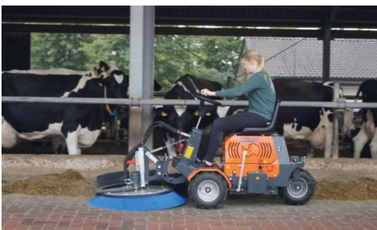
Рисунок 4 – Самоходный пододвигатель с роторным рабочим органом марки Трас MINI 3
