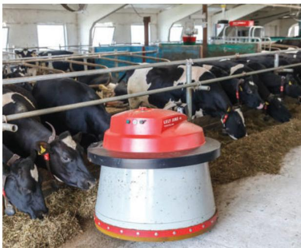
Рисунок 13 – Роботизированный пододвигатель с роторным рабочим органом Juno 100
