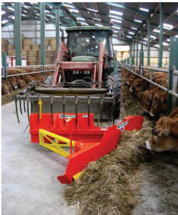
Рисунок 12 – Прицепной пододвигатель со скреперным рабочим органом марки Fourragenet
