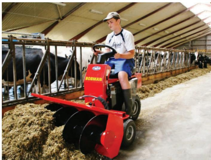
Рисунок 2 – Самоходный пододвигатель со шнековым рабочим органом BOBMAN PRO
