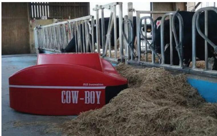
Рисунок 16 – Робот-подталкиватель кормов COW-BOY
