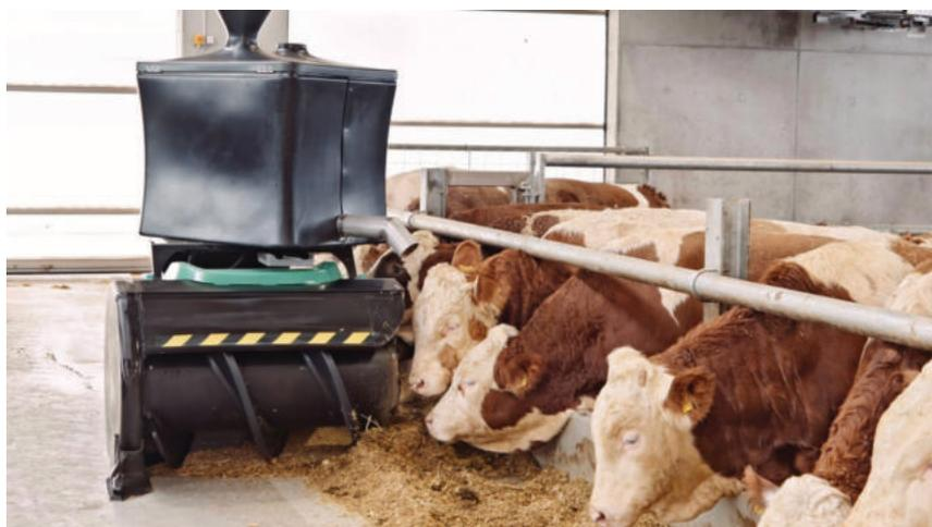
Рисунок 15 – Роботизированный пододвигатель со шнековым рабочим органом марки Butler Gold
