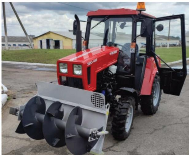
Рисунок 10 – Навесной подталкиватель кормов компании «Юликом Плюс»
