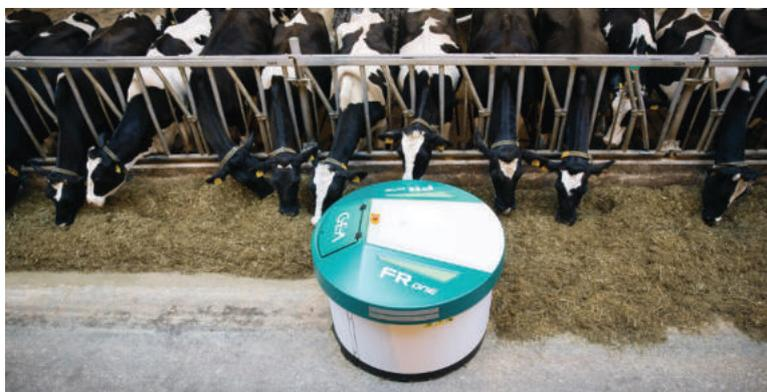
Рисунок 17 – Автоматизированный кормовой толкатель FRone
