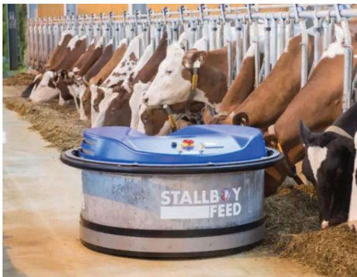
Рисунок 22 – Роботизированный пододвигатель кормов Stallboy feed
