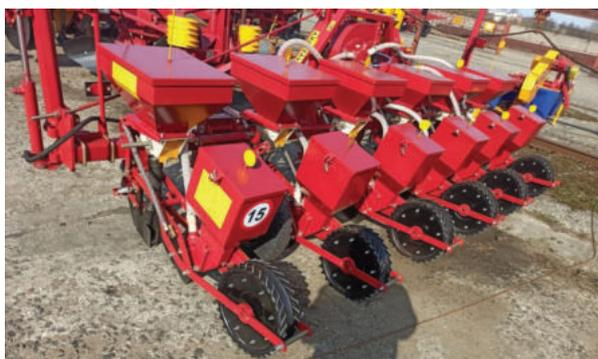
Рисунок 1 – 6-секционная сеялка точного высева СПЧ-6ЛТ (ОАО «Управляющая компания холдинга «Лидсельмаш»)
