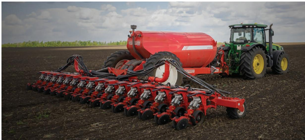
Рисунок 4 – Сеялка точного высева CHRONO 900 (MASCHIO GASPARDO, Италия)
