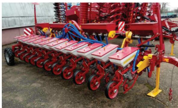
Рисунок 2 – 12-секционная сеялка точного высева СТВ-12У (ОАО «Лидсагропромаш»)
