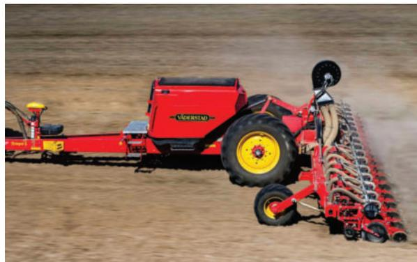
Рисунок 6 – Сеялка точного высева Tempo L 16 Central Fill (Väderstad, Швеция)
