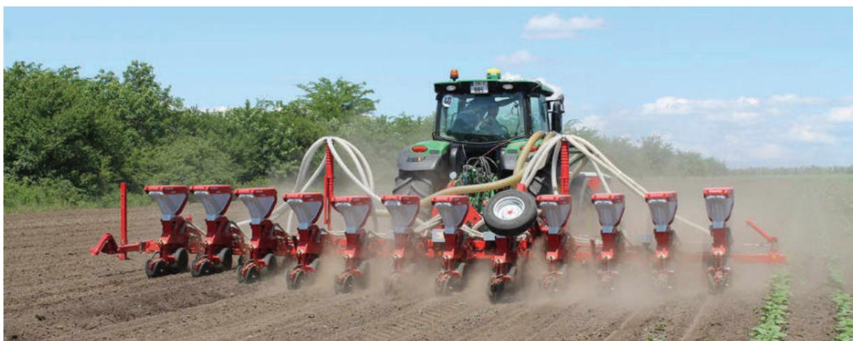
Рисунок 3 – 12-секционная сеялка точного высева СКП-12 КУ «Берестье» (ОАО «Брестский электромеханический завод»)
