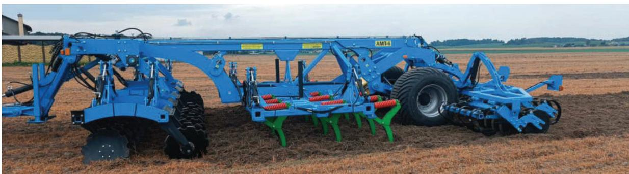
Рисунок 2 – Агрегат почвообрабатывающий модульный к тракторам мощностью 400–450 л. с.
