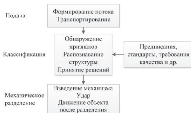
Рисунок 1 – Функциональная схема системы сортировки плодов по качеству
