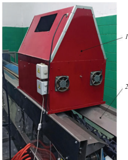
Рисунок 4 – Фотомодуль системы технического зрения, установленный на главном конвейере: 1 – фотомодуль СТЗ; 2 – главный конвейер
