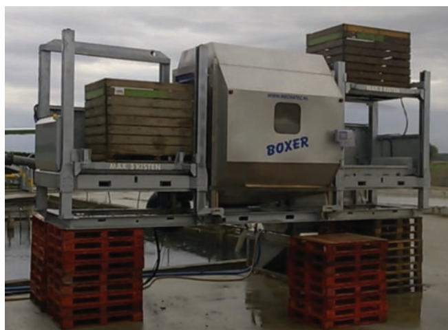
Рисунок 3 – Машина для мойки и дезинфекции тары Boxer фирмы Mechatec
