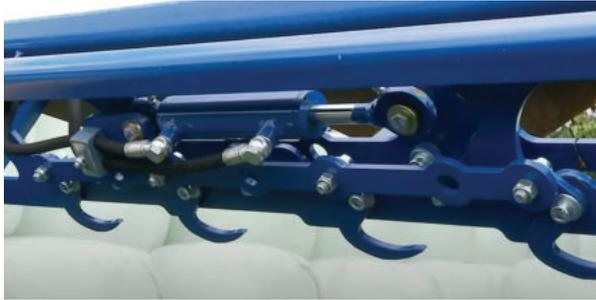
Рисунок 7 – Двойной крючковый захват полимерной упаковки резчика фирмы GÖWEIL
