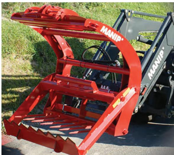
Рисунок 10 – Резчик рулонов фирмы MANIP' (Франция)
