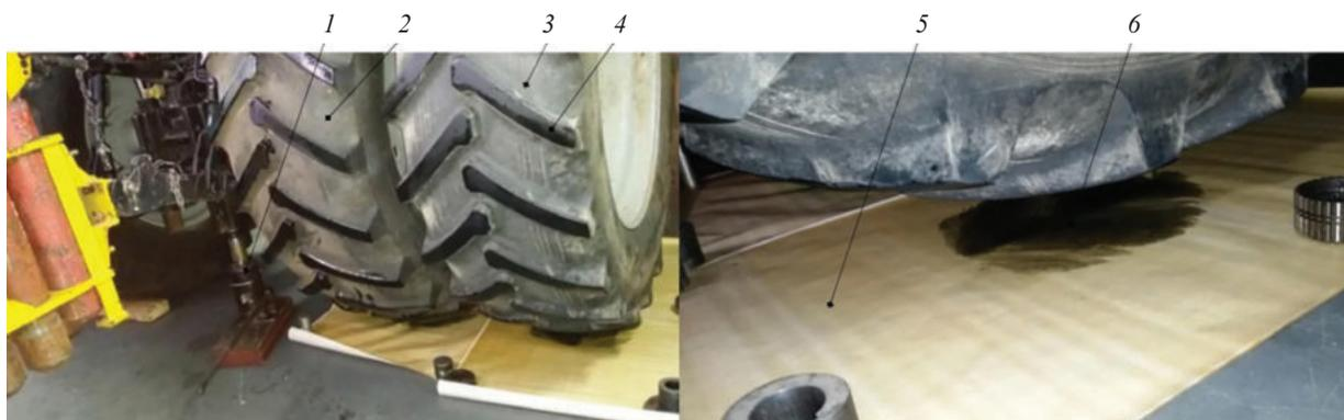
Рисунок 2 – Определение контурной площади пятна контакта шин трактора «Беларус-2022.5» на жестком основании: 1 – домкрат; 2 – основное внутреннее колесо; 3 – дополнительное наружное колесо; 4 – красящее вещество на грунтозацепях протектора; 5 – миллиметровая бумага; 6 – отпечаток пятна контакта
