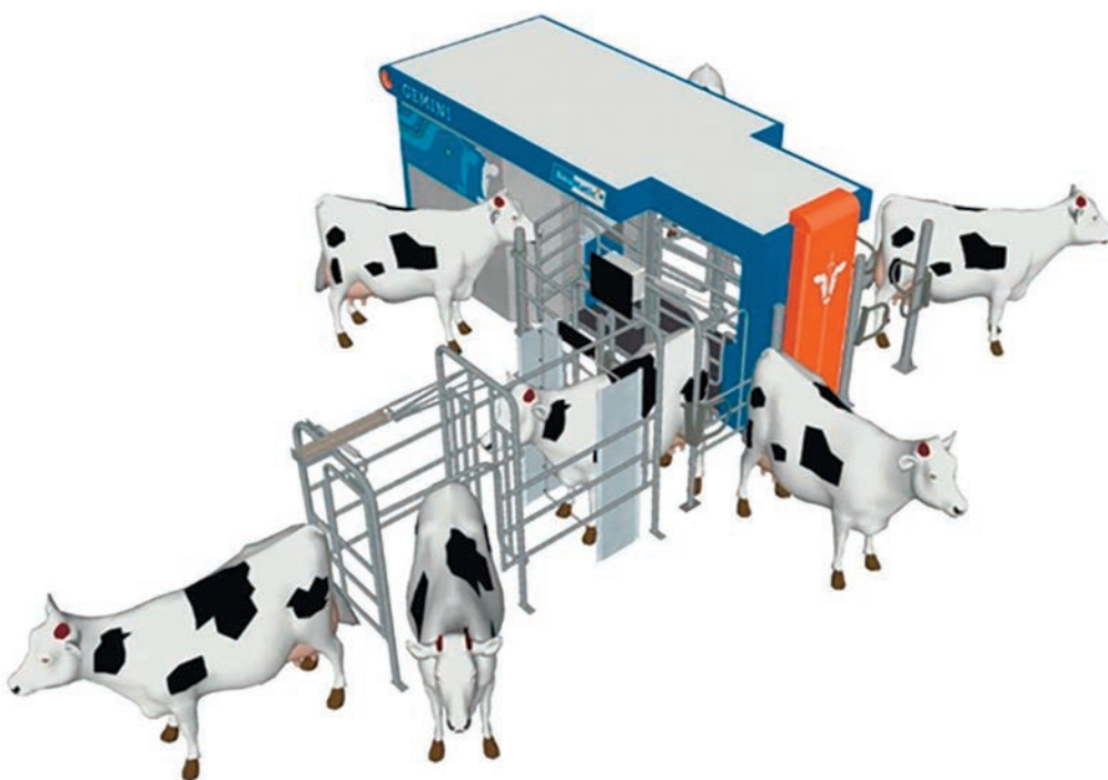
Рисунок 2 – Роботизированная доильная установка «Дубль-бокс»
